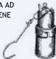
LAMPADA AD ACETILENE PER ILLUMINARE IL CANTIERE DI LAVORO
